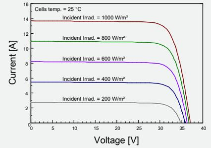
**P-V CURVES OF PV MODULE(400W)**
